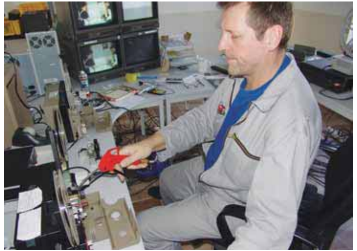
Ein kurzer Schuss aus der Druckluftpistole und die Fussel sind aus dem Bildfenster verschwunden.
